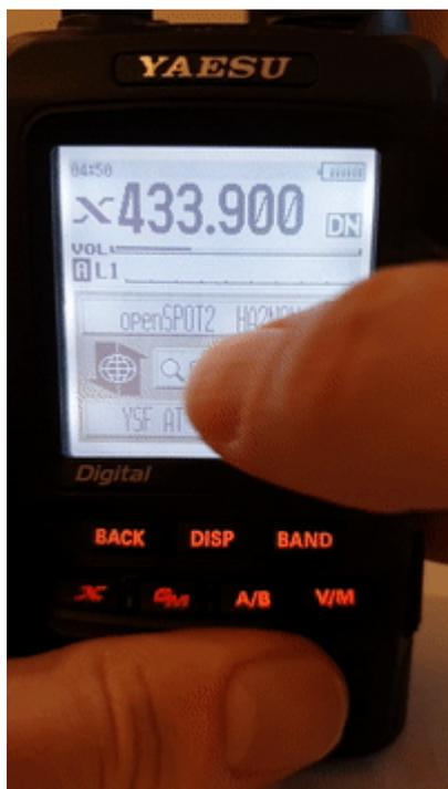
Sie können einen Teil des Servernamens eingeben. Alle passenden Server werden aufgelistet. Um zu einem Server zu wechseln, wählen Sie ihn mit dem Drehregler aus und drücken Sie kurz die PTT-Taste (oder tippen Sie bei einem Touch-Display einfach darauf).
