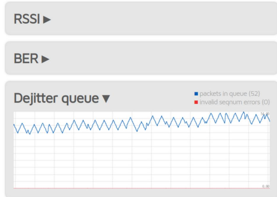
Der **RSSI-Diagramm** zeigt die Empfangssignalstärke des Modems an. **BER-Diagramm** zeigt die empfangene Bitfehlerrate während eines Anrufs an. Die BER wird auch für Pakete berechnet, die vom Netzwerk empfangen werden, nicht nur vom Modem. Die **Diagramm der Dejitter-Warteschlange** (wird nur angezeigt, wenn *Erweiterter Modus* ist aktiviert) zeigt die Anzahl der Pakete an, die in der Dejitter-Warteschlange warten.
