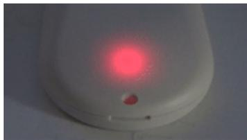
Eine kurzzeitig leuchtende gelbe LED während der Übertragung signalisiert eine ungültige empfangene Paketsequenznummer (was einen Paketverlust im Netzwerk bedeutet).
