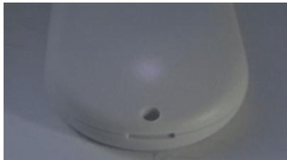
Eine weiße Status-LED bedeutet, dass der integrierte AP-Modus (Access Point) des openSPOT4 aktiviert ist.
